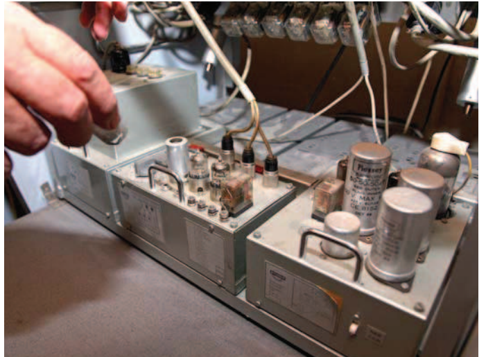
Netzteil und Stabilisierungseinschübe der Studer C37
