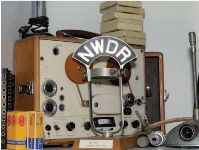
Wahre Schätzchen: Haltevorrichtung für Neumann M49 vor Maihak MMK 6 Reportage-Tonbandgerät mit Federwerk-Antrieb
