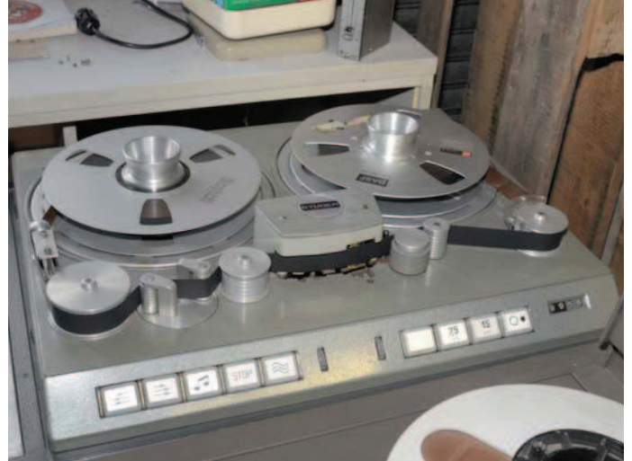
Aus dem Hamburger „Star-Club“: Einzoll-Studer J37, ursprünglich mit vier Spuren, später umgebaut auf acht Spuren
