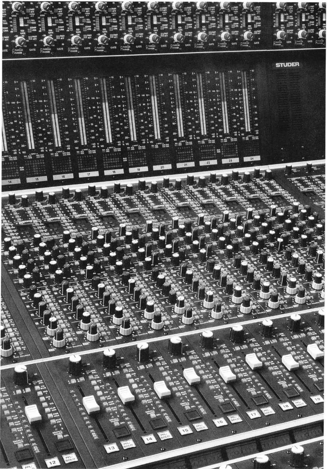
„Studer 990“ – Inline Produktionskonsole mit digitaler Steuerung.
