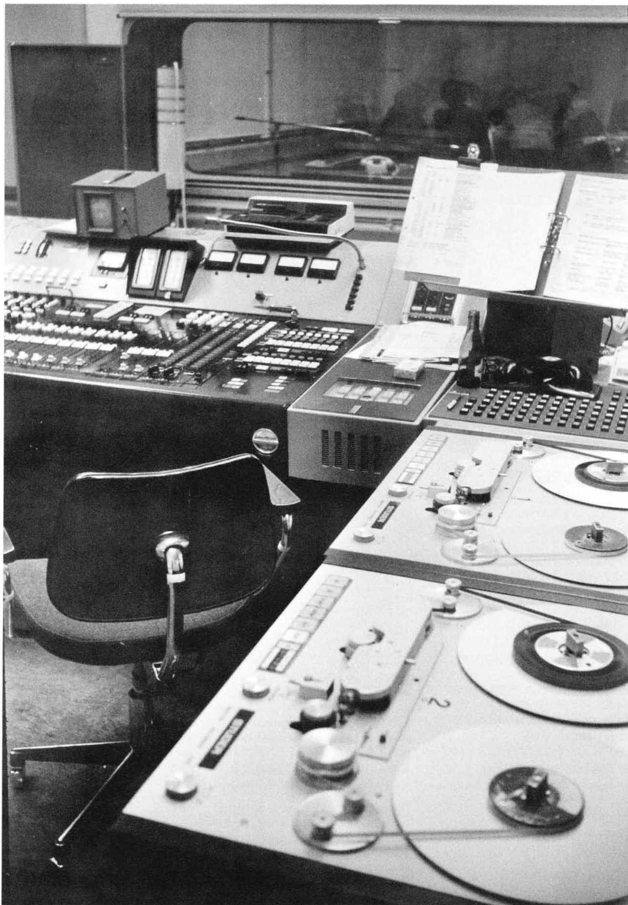
Bild von 1978: Diese Studer A80 waren im Einsatz beim Österreichischen Rundfunk im Funkhaus Linz.
