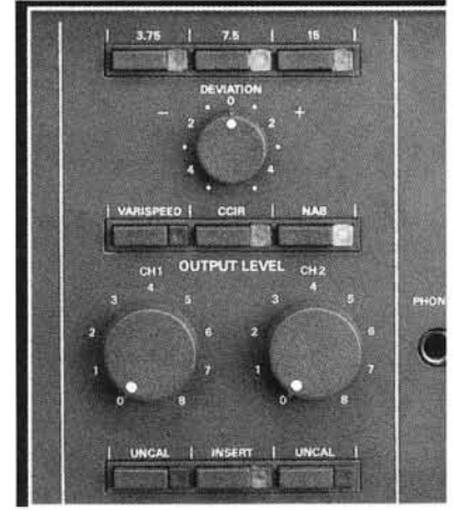
A807: Bandzählwerk und Laufwerkfunktionen, Aussteuerung und Betriebsartenschalter, 3 Bandgeschwindigkeiten, Variospeed, Entzerrung.
