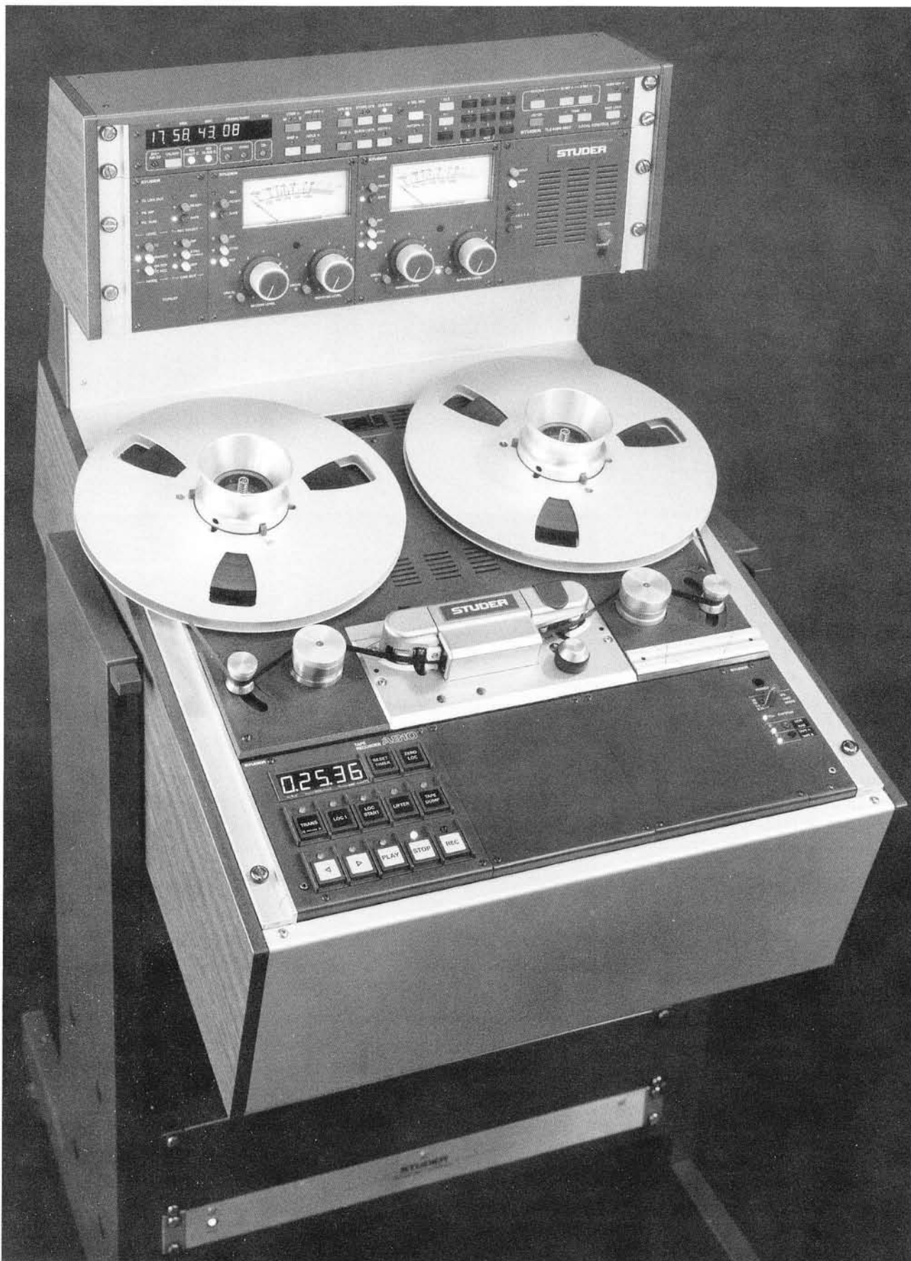
Studer A810 in VU-Konsole: Über das Bedienfeld lässt die Maschine sich programmieren.
