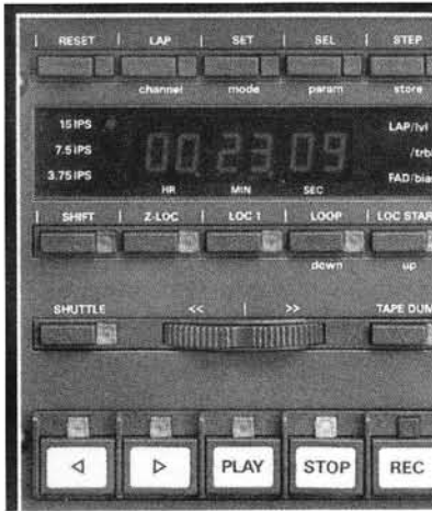
A807: Bandzählwerk und Laufwerkfunktionen, Aussteuerung und Betriebsartenschalter, 3 Bandgeschwindigkeiten, Variospeed, Entzerrung.
