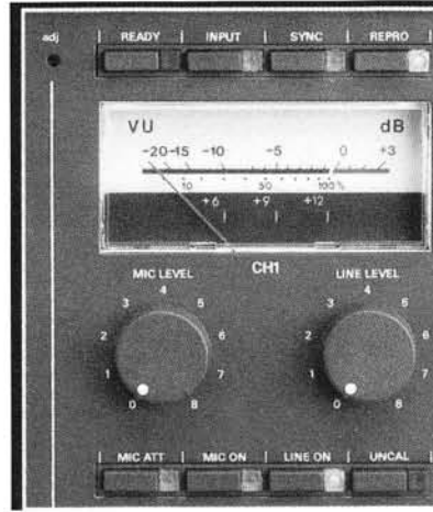
A807: Bandzählwerk und Laufwerkfunktionen, Aussteuerung und Betriebsartenschalter, 3 Bandgeschwindigkeiten, Variospeed, Entzerrung.
