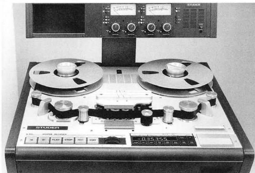
Die Studer A820 als 1-Zoll-Master-Recorder. Die Maschine zeichnete sich durch eine niedrige Laufwerkshöhe aus. Laufwerk- und Audioelektronik waren steckbar und von vorne zugänglich.
