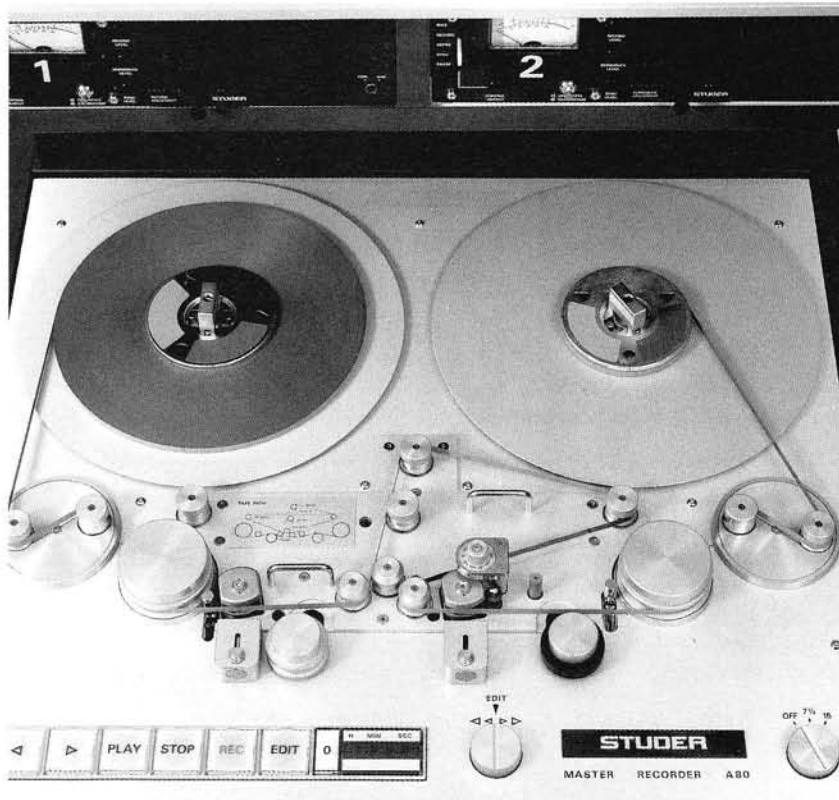
A80 VU mit Vorabhörschleife zur Steuerung einer Schallplatten-Schneidemaschine.
