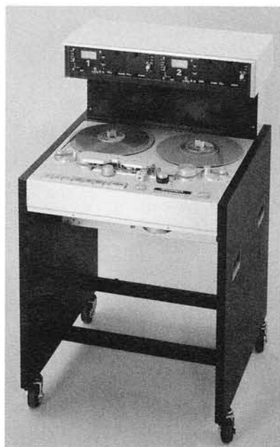
A80 in einer Konsole. Die steckbaren Verstärkereinheiten sind oberhalb des Laufwerkes angeordnet.
