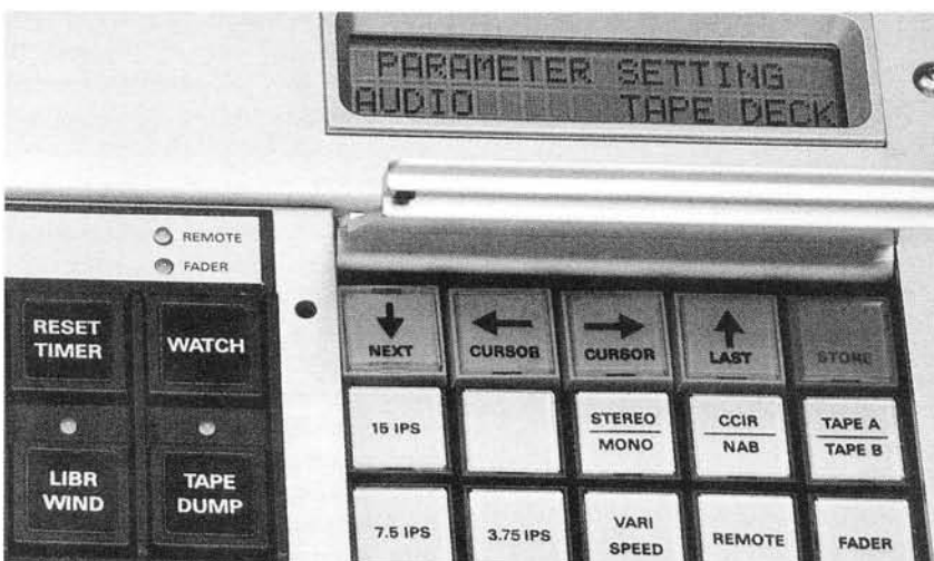
Hinter einer Klappe liegen die Programmier Tasten für die Menüauswahl (obere Reihe) und die Speicherung (die unteren zwei Reihen).
